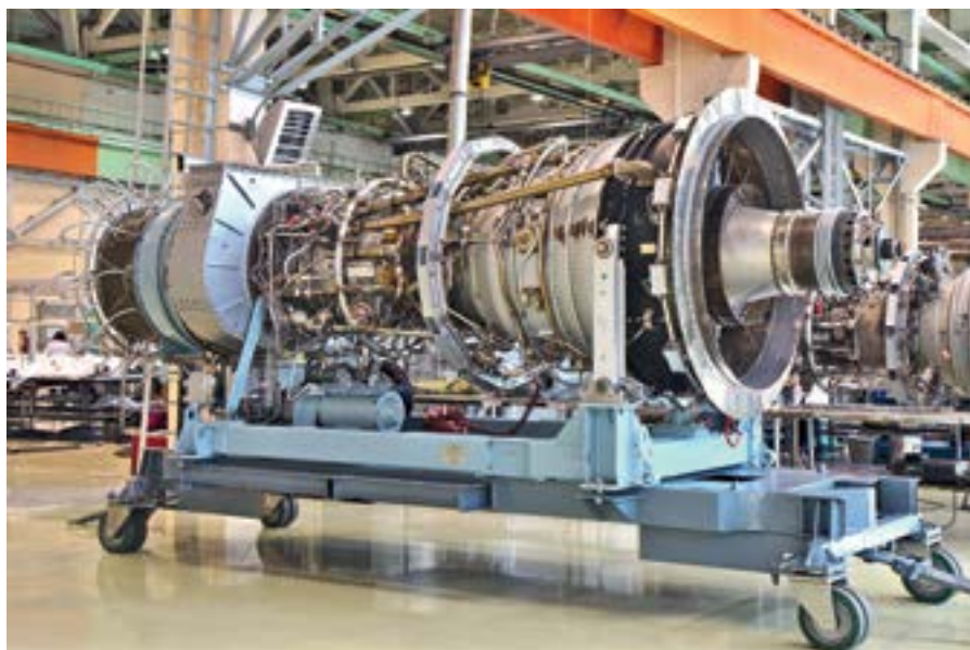
Фото 2. Газотурбинный двигатель ПС-90ГП-25А – эффективный привод для энергетических установок
