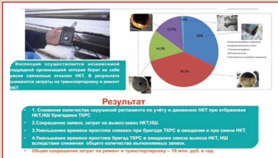
Рис. 4. Инспекция НКТ на устье скважин, распределение причин отбраковки труб
