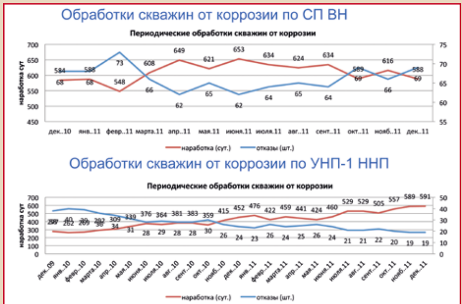
Рис. 8. Динамика наработки на отказ подверженных коррозии скважин, на которых проводится ингибирование от коррозии
