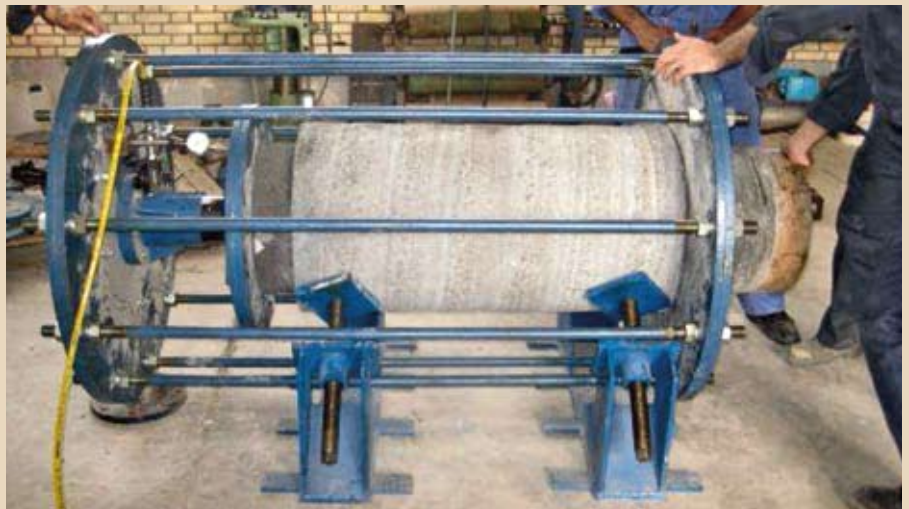
Рис. 2. Оборудование для проверки адгезии бетона к покрытию испытанием усилия на сдвиг
