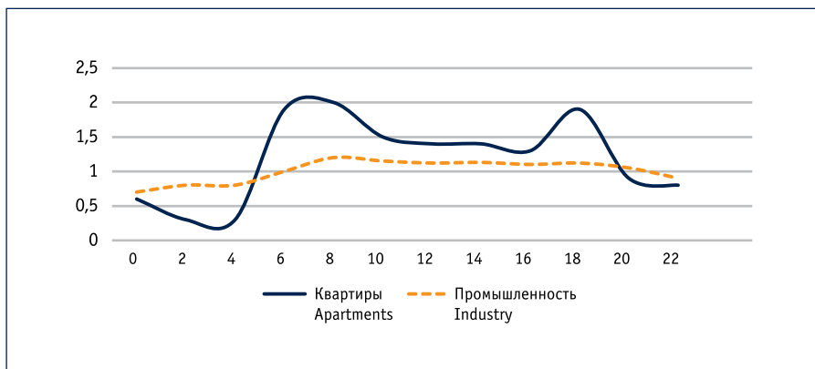
Рис. 3. Пример распределения коэффициента часовой неравномерности [7]
