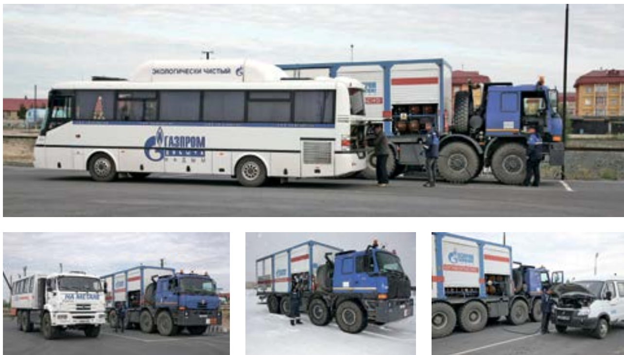
Рис. 2. Передвижные автомобильные газозаправщики ПАГЗ
